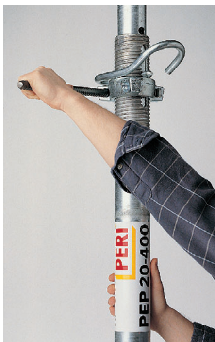
Stojka PEP se dá snadno a šetrně seřizovat a spouštět pomocí táhla i při plném zatížení.
