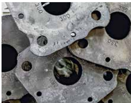
Dobře čitelné je vyražené označení délky stojky PEP Ergo.
