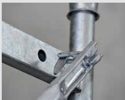
Diagonální výztuha ST 100 má na jednom konci osazovací háček a na druhém konci západku. Montáž tak může probíhat velmi rychle.
