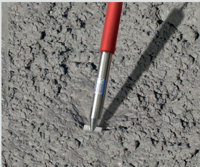
senzor vodního součinitele betonu
