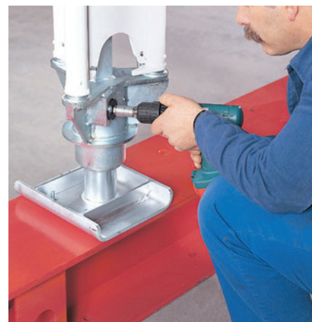
Spouští se vrtačkou resp. el. šroubovákem běžné jakosti s klíčem 19 mm. (bez přiklepu)
