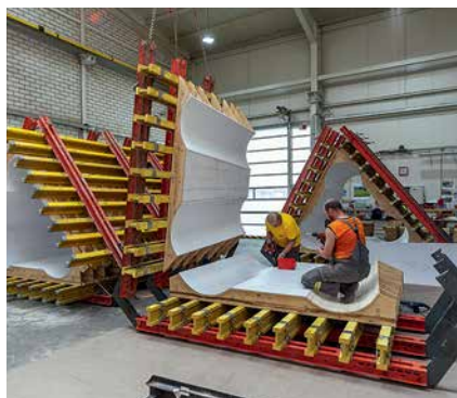
Výroba formy stromosloupu v montážní hale PERI v Jesenici.
