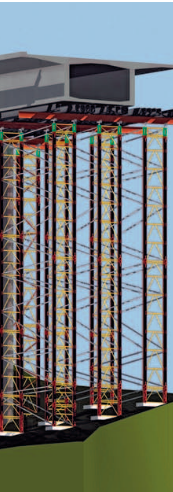
Typický příklad použití při výstavbě mostů. Vysokopevnostní věže VARIOKIT vysoké cca 5,00 - 40,00 m.
