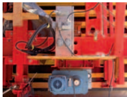
Pro přemísťování je možné v případě potřeby použít elektrický pohon. Může být také dodatečně namontován na nákokle ozubeného kola.
