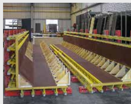
Výroba segmentů bednění pilíře se zkosenými hranami.
