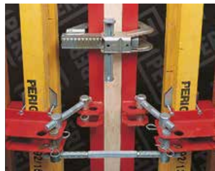
Zámek BFD spojuje panely; stavěcí vřetena jsou použita pouze při přemístění sestav panelů.
