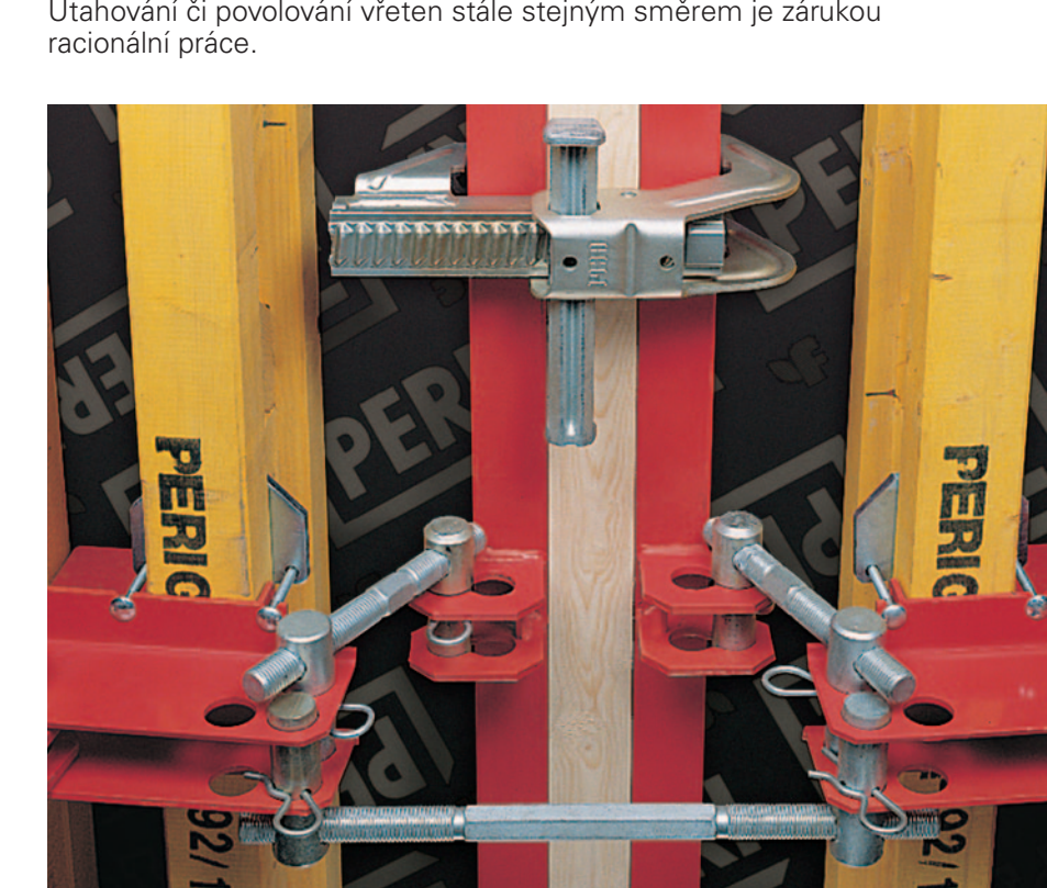
Napínací vřeteno 500 se nasadí do Tzávor a zajistí se závěškami 5/1.
