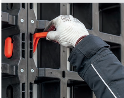
Klip DUO se jednoduše zasune do podélného otvoru v rámu a otočením o 90° se upevní. Toto spojení umožňuje rovné vyrovnaní
